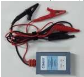
Блок питания датчиков поэлементного контроля № 1
